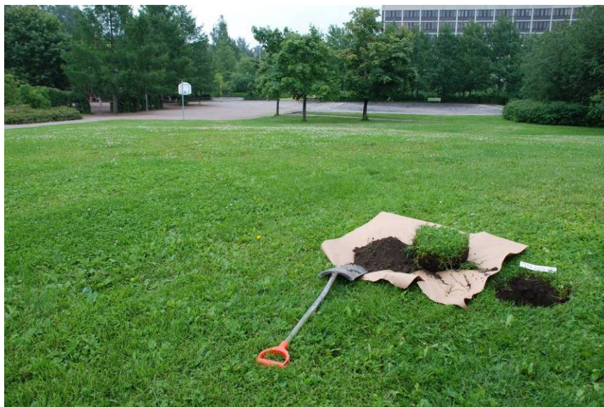
Kuva 1. Täyttömaan näytteenottopiste Helsingin Munkkiniemessä heinäkuussa 2009. Kuva: Timo Tarvainen
